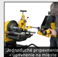
Výroba obvodových drážok
